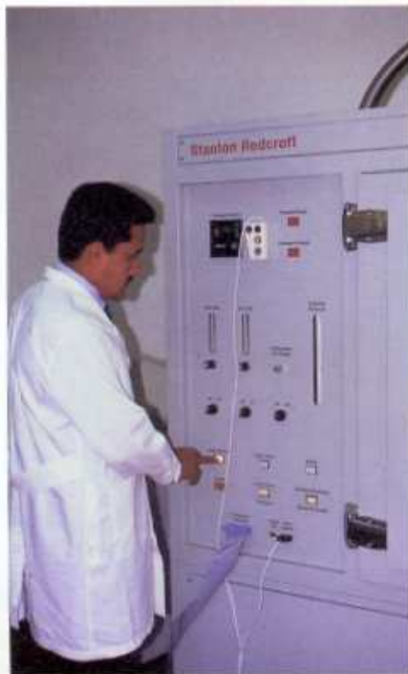
Cámara de Humos
